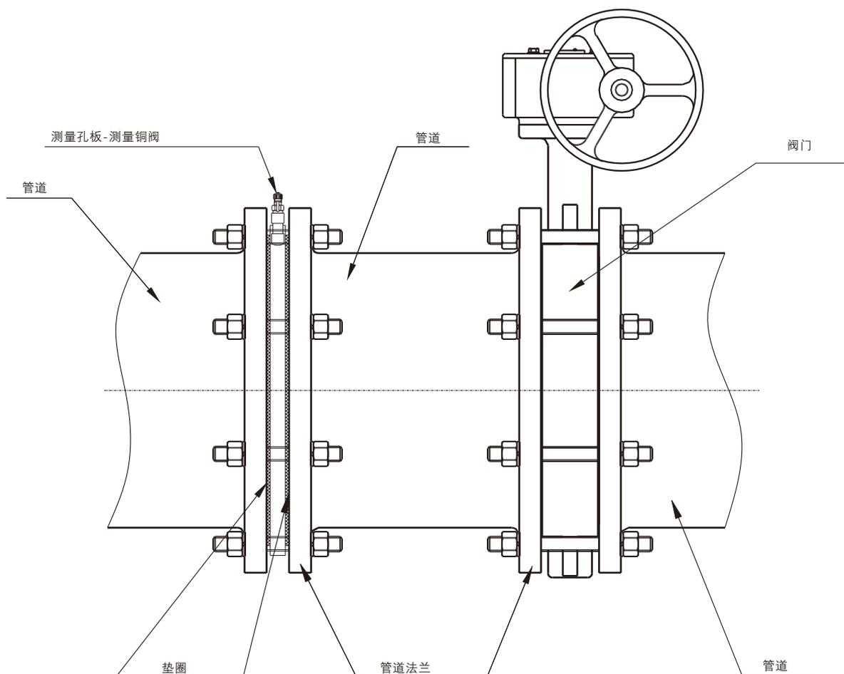
孔板Fig.8100可安装在符合BS EN 1092-2标准的PN10、PN16或PN25等级的阀门和（或）管道法兰之间。
